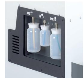
Doté de 2 réservoirs d'huile fraîche et d'un réservoir d'additif UV, le COOLIUS 50 est parfaitement équipé pour les systèmes de climatisation sur les véhicules hybrides et électriques.
