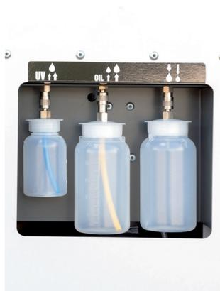
Riempimento dell'olio esatto e variabile. Grazie a una funzione di lavaggio interno, il tipo di olio può essere cambiato molto facilmente, ad esempio da olio PAG a POE e viceversa. Ciò consente l'utilizzo su tutti i tipi di compressore, compresi i veicoli ibridi ed elettrici.
