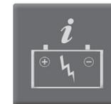
**Monitoramento da tensão da bateria do veículo:** Quando conectado ao veículo, o W.EASY Box 2.0 determina a tensão da bateria e ajusta-se automaticamente a alimentação do veículo, seja 12 ou 24 volts. E se a tensão estiver muito baixa ou alta, o W.EASY Box 2.0 avisa através de um sinal sonoro e luminoso.
